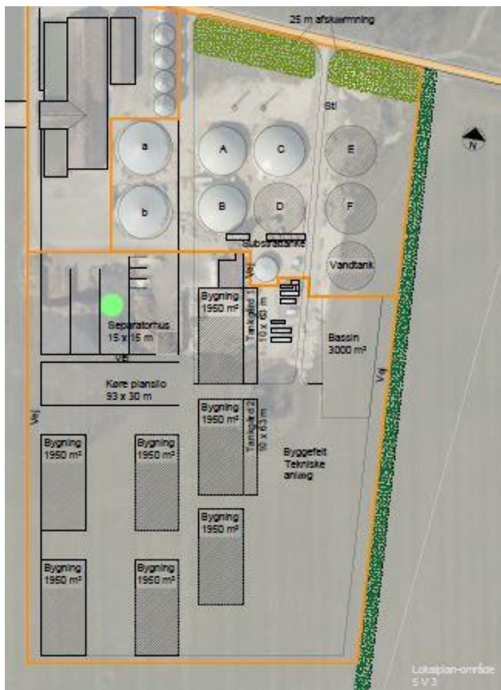
Figur 2 - Oversigt over nuværende og fremtidigt anlæg. Fremtidige elementer er gråskraveret. Beplantningsbælter ses øverst og til højre (grønskraveret). Beplantning mod vest ligger udenfor det angivne projektområde.
