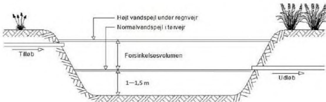
Figur 2 – Principskitse for vådt forsinkelsesbassin
