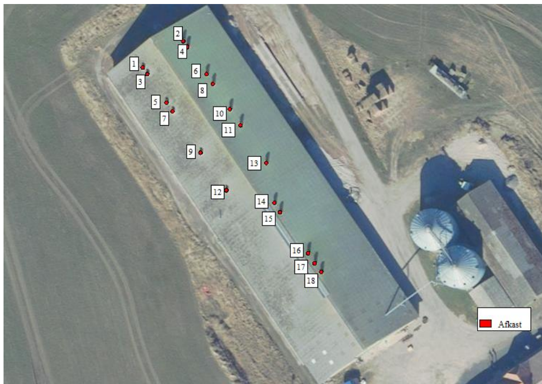
Figur 1. Placering af ventilationsafkast
