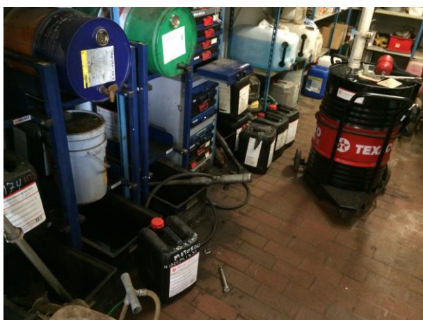
Opbevaring på tæt gulv uden afløb til kloak.
