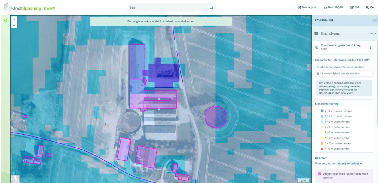
Figur 8: Grundvandshøjde omkring husdyrbruget om vinteren. Kilde: kamp.miljøportal.dk
