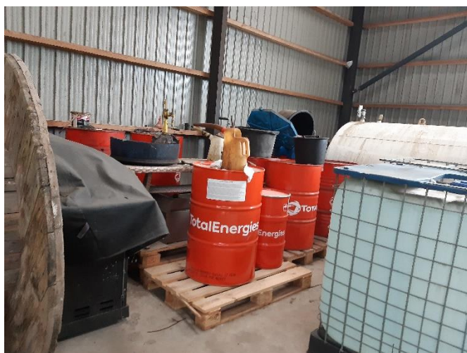
Foto 6 oplag af olie uden for spildbakke og olieaffald på spildbakke (bagerst)
