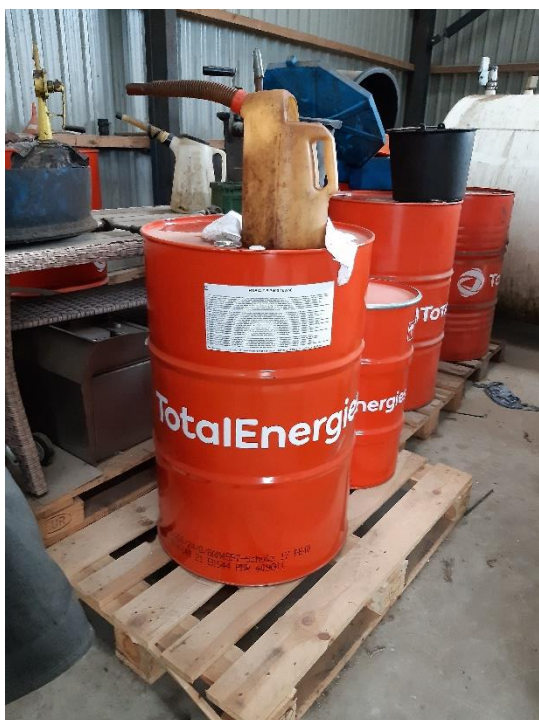
Foto 5 oplag af olie uden for spildbakke
