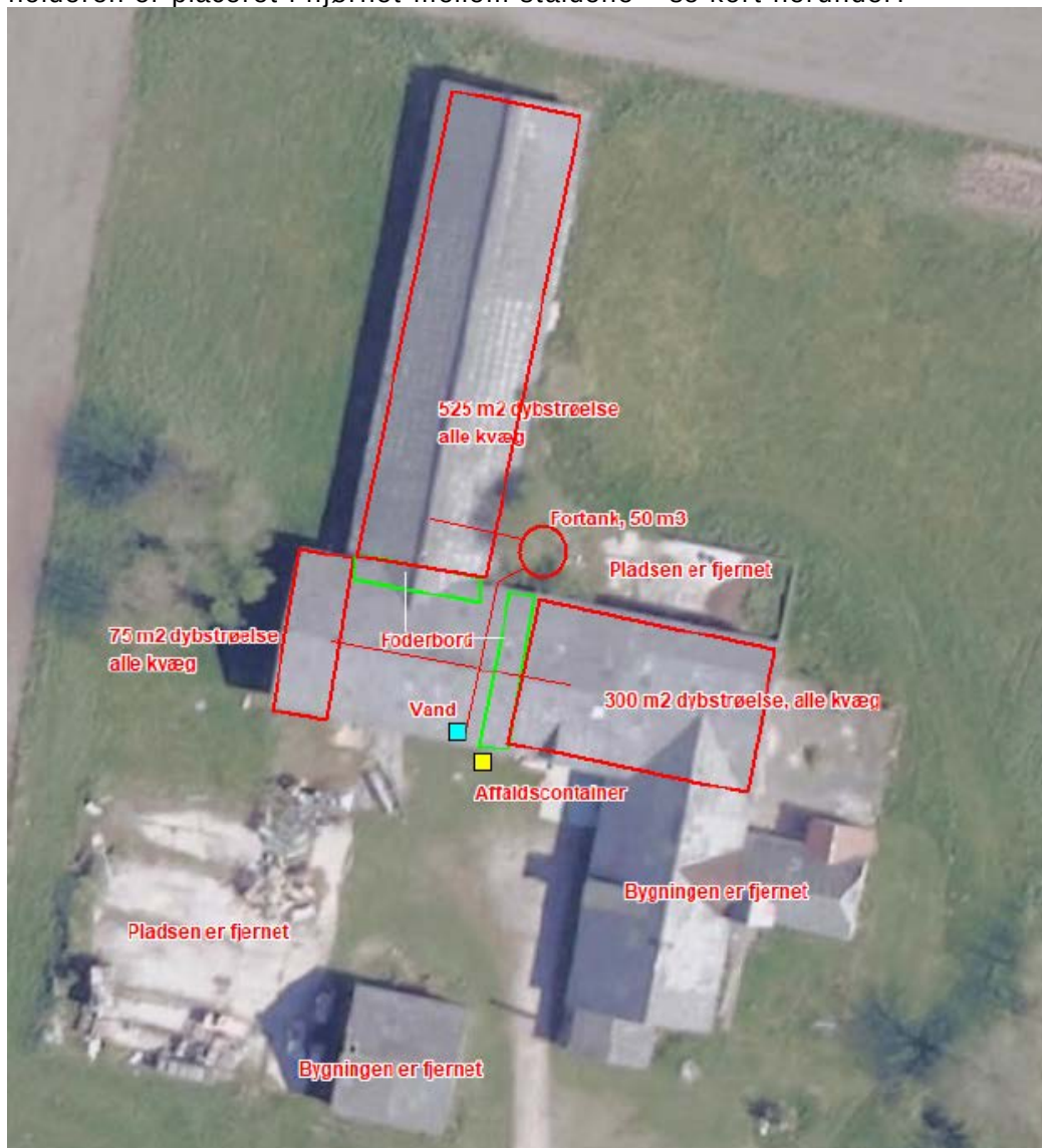
Figur: Afløbsforhold samt placering af fortank.
