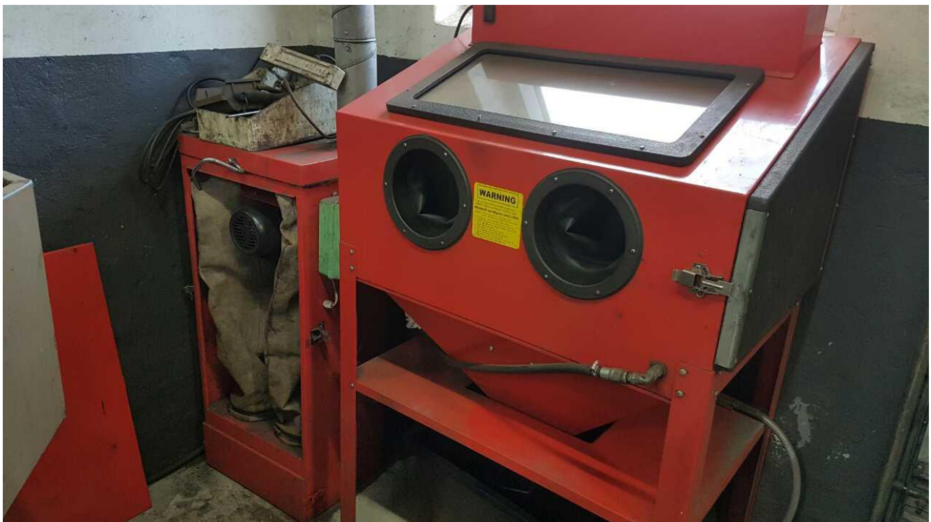
Sandblæser med posefilteranlæg.
