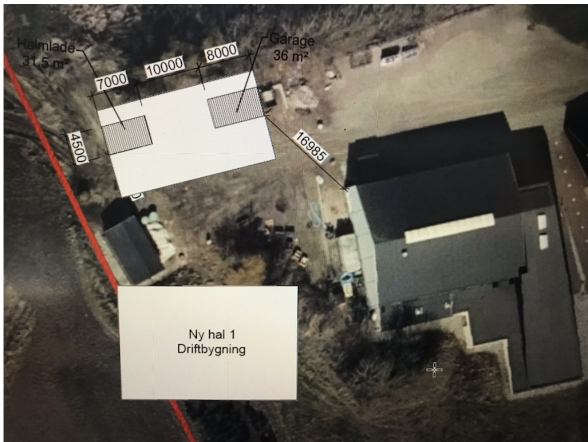
Figur 1: Den ønskede placering af det nye maskinhus/garage og den nye halmlade (grå markeringer) inden for det godkendte byggefelt (hvid markering).
