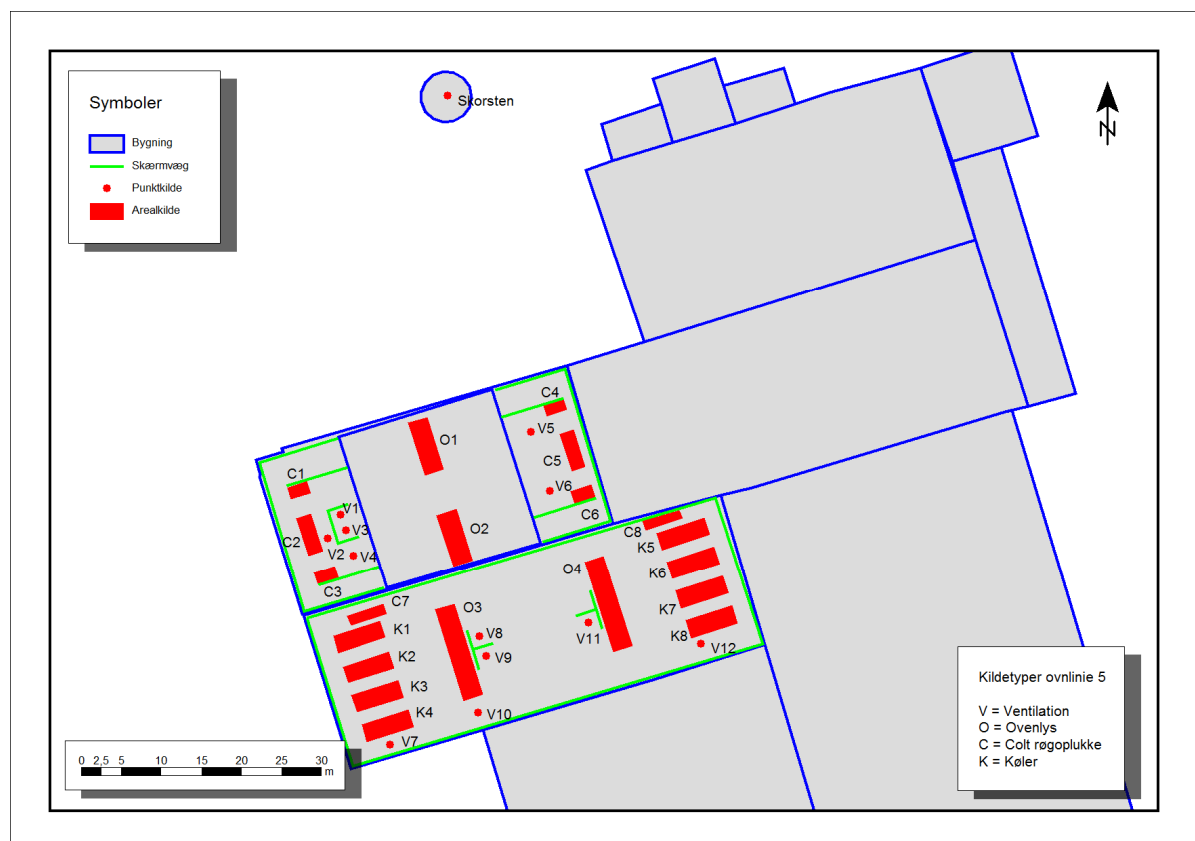
Figur 6; Støjkloder på tag af ovnhal og røgrensningsbygning til ovnlinie 5
