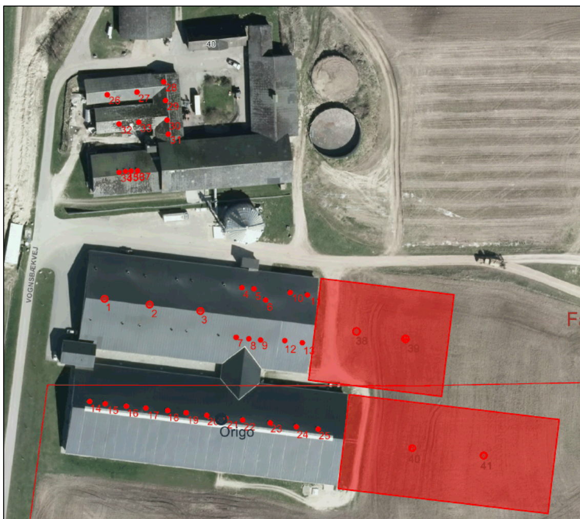
FIGUR 3A PLACERING AF VENTILATIONSFAKAST – ETAPE 1.
