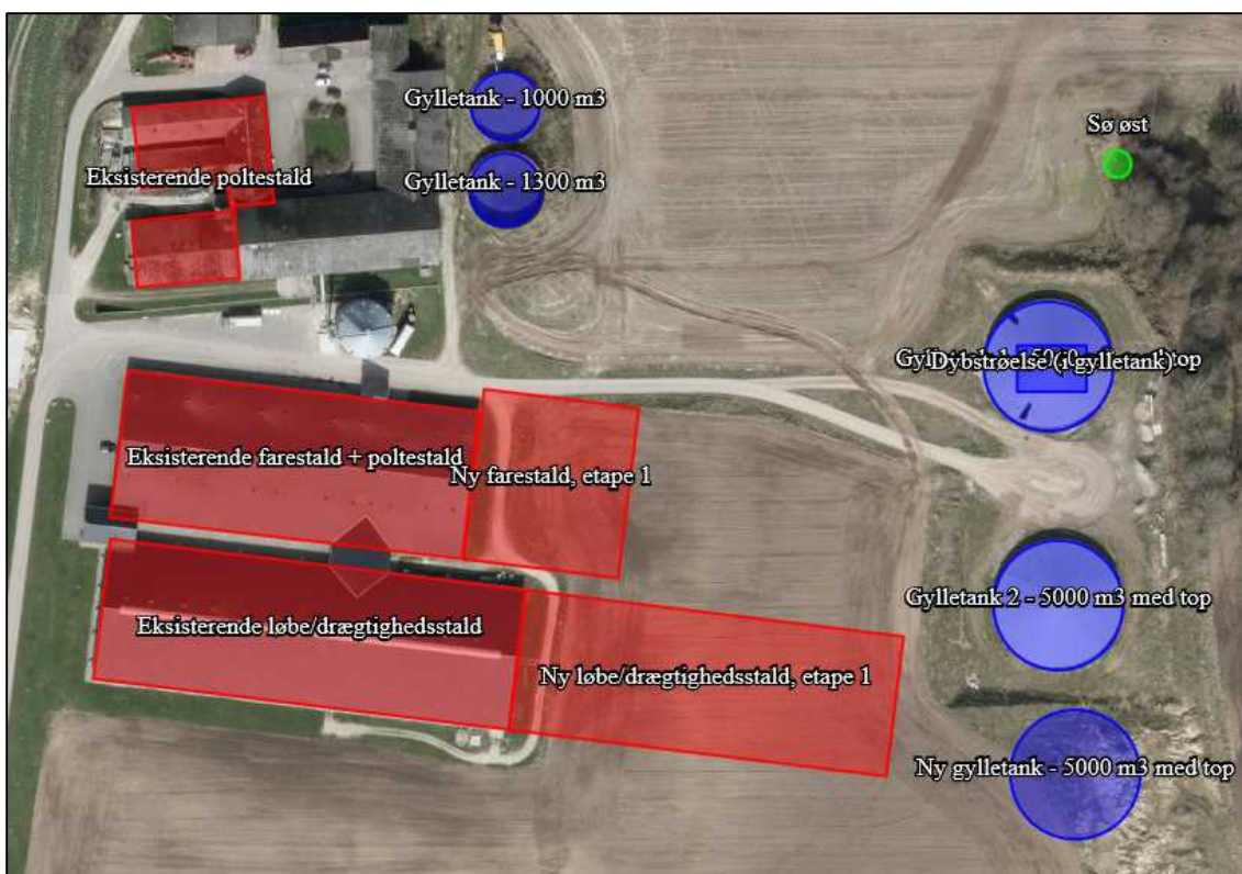
FIGUR 2A PLACERING AF STALDAFSNIT – ETAPE 1 (DOG OPFØRES DEN NYE GYLLEBOLDER FØRST I ETAPE 2)
