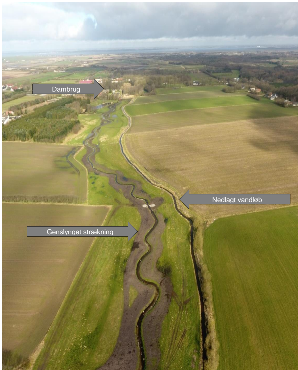
Oversigt over nyt forløb af Hasseris å efter nedlæggelse af opstemning og fisketrappe i 2020.
