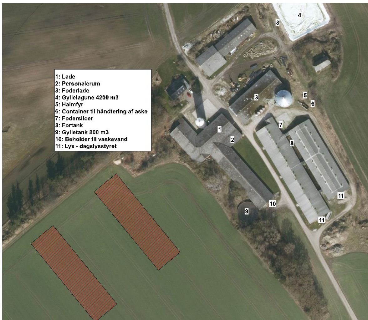
Figur 5. Anlægstegning af Vårvej 38/40.
