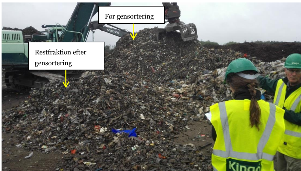
Foto 8. Gensortering af mellemfraktion på Etape 2. Fotoet viser affaldsfraktionernes
