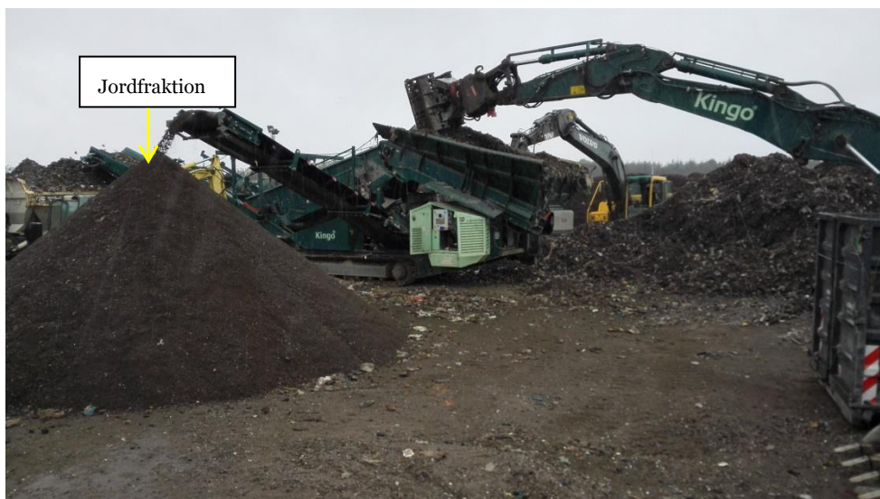
Foto 4. Sorteringsmaskine etableret på Etape 2. Fotoet viser jordfraktionen fra gensorteringen.
