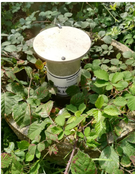
Moniteringsboring EK14 N for deponiet, nedstrøms. Boringen er aflåst, har låg og er mærket med nr. Boringen er ikke forsynet med DGU. nr. (130.891?)
