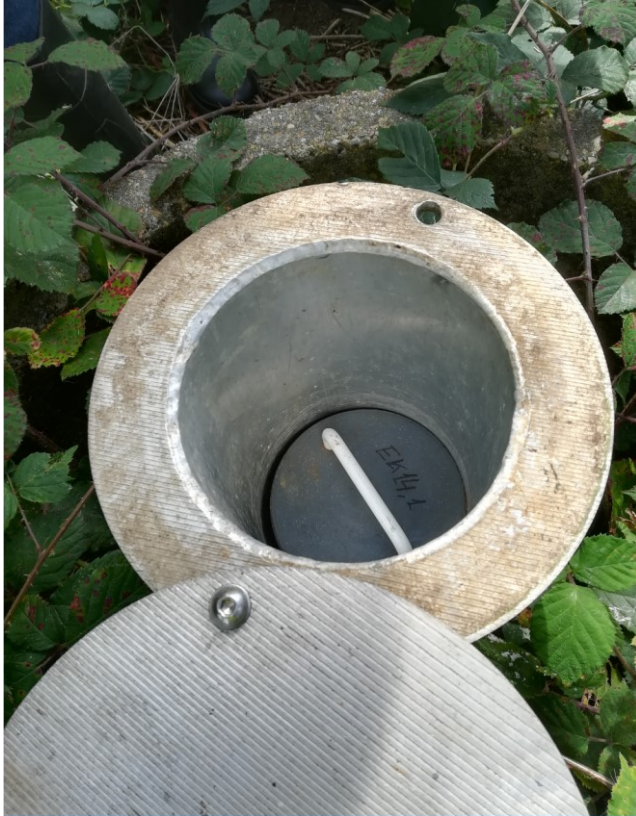
Moniteringsboring EK14 N for deponiet, nedstrøms. Indvendig er der hætte på forerøret. Boringen er noteret med lokalt nr. men ikke forsynet med DGU. Nr.
