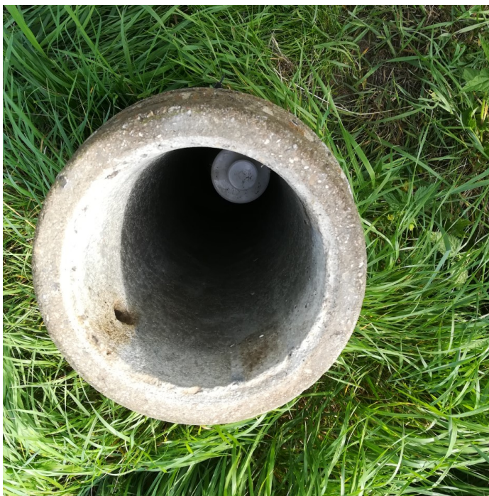
RAK12 indvendig, der er tætsluttende låg på forerøret.
