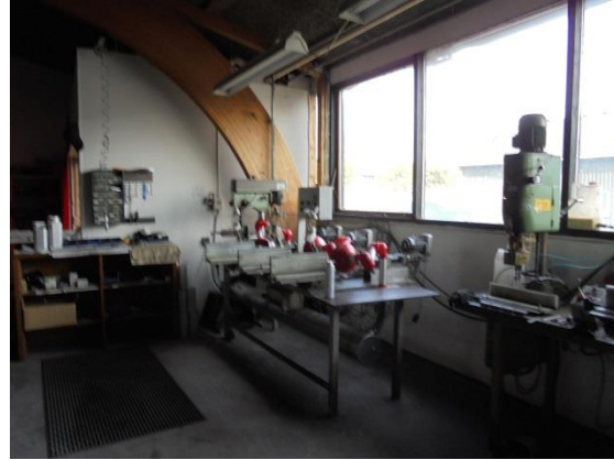
Maskine, hvorfra der udsuges køle-/smøremidler, der ledes til afkast B
