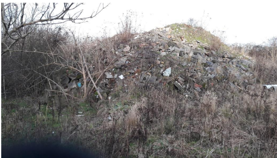
Fig. 4 Bunke med betonbrokker med indslag af mosaik, klinker og plast.
