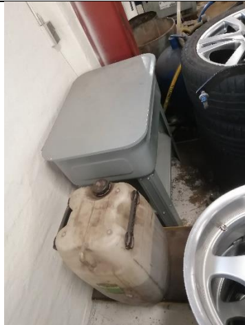
Billede 3: Rensevæske til rensebær uden spildbakke, som skal være under dunken. Da der er afløb i lokalet, vil der ved evt. spild være en risiko for, at rensesvæsken løber ud med spildevandet.
