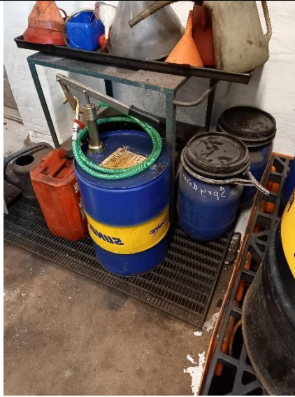
Billede 7: Opbevaring af spraydåser spildolie m.v. på spildbakke
