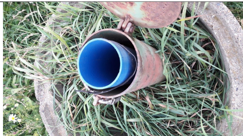
Boringen er placeret i marken nedstrøms for lossepladsen og filtersat i det terrænnære sekundære grundvandsmagasin. Mangler DGU nr.
