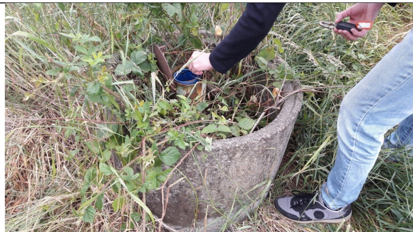
Boringen er placeret nedstrøms i randen af lossepladsen og filtersat i det terrænnære sekundære grundvandsmagasin.
