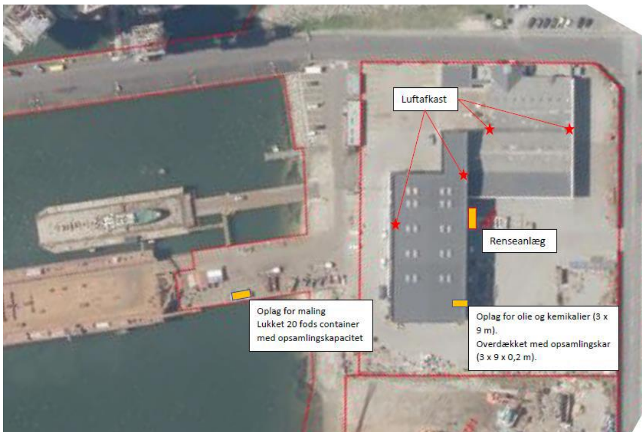
Fig 3: Placering af frie installationer, renseanlæg samt luftafkast.
