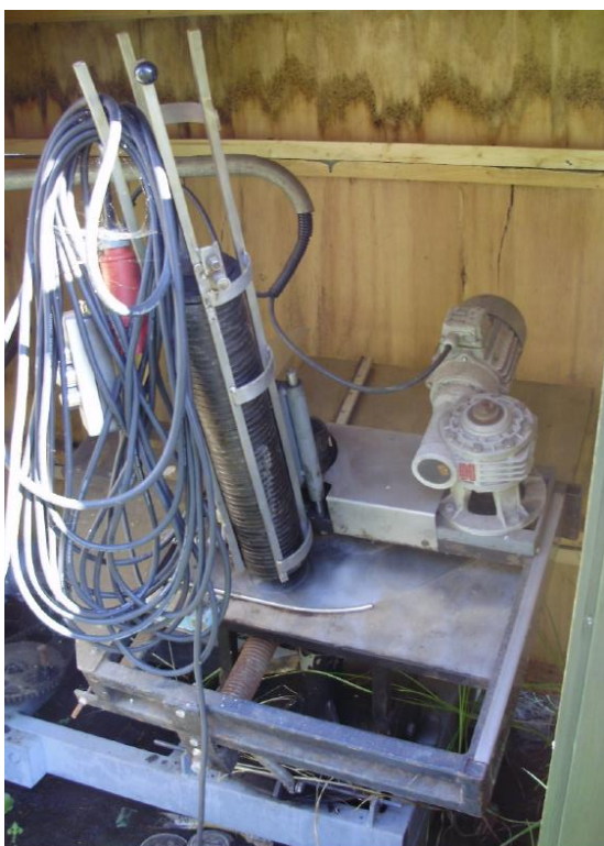
Figur 2. Billede af kastemaskine til bagduer. En stilbar fjeder og vinklen på bordet er med til at styre duernes fart, højde og længde. En metalskinne på bordet styrer duens vinkel horisontalt.
