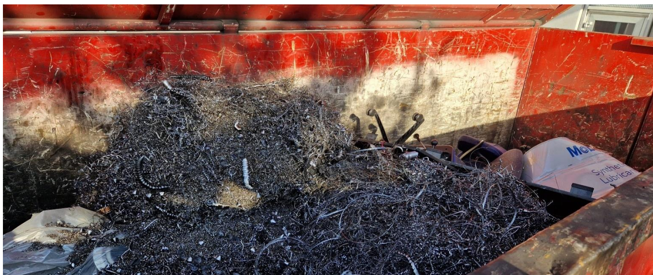
Container til metalaffald. Spåntagende foretages som tørfræsning – dvs. uden brug af køle-/smøremiddel.
