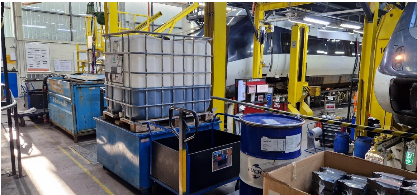
Opbevaring af flydende råvarer med spildsikring ved værkstedsspor for IC4.
