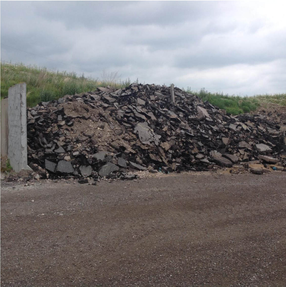
Foto 4: bunke af asfalt, der skal flyttes til befæstet areal.
