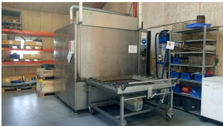
Billede nr. 7: Vaskemaskine i MW-gearværksted.
