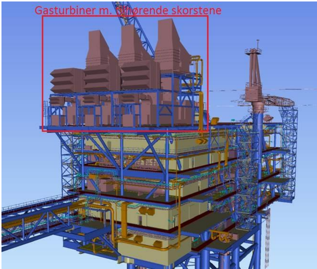
Figur 2: Gasturbinernes placering på Tyra East G
