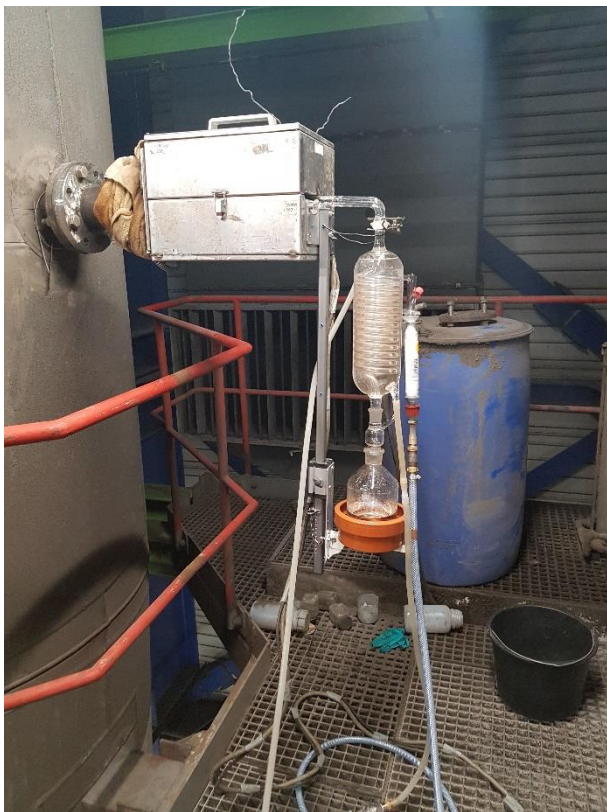
Opstilling til måling af dioxin
