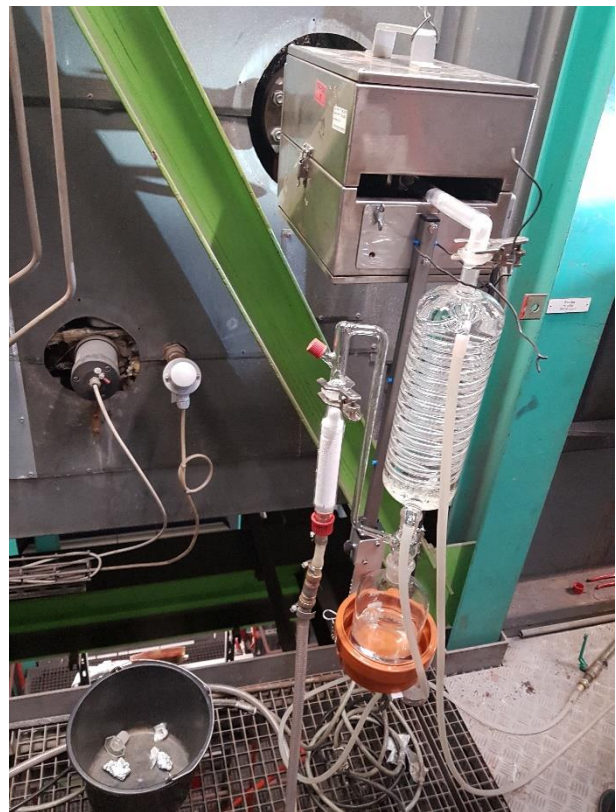
Opstilling til måling af dioxin
