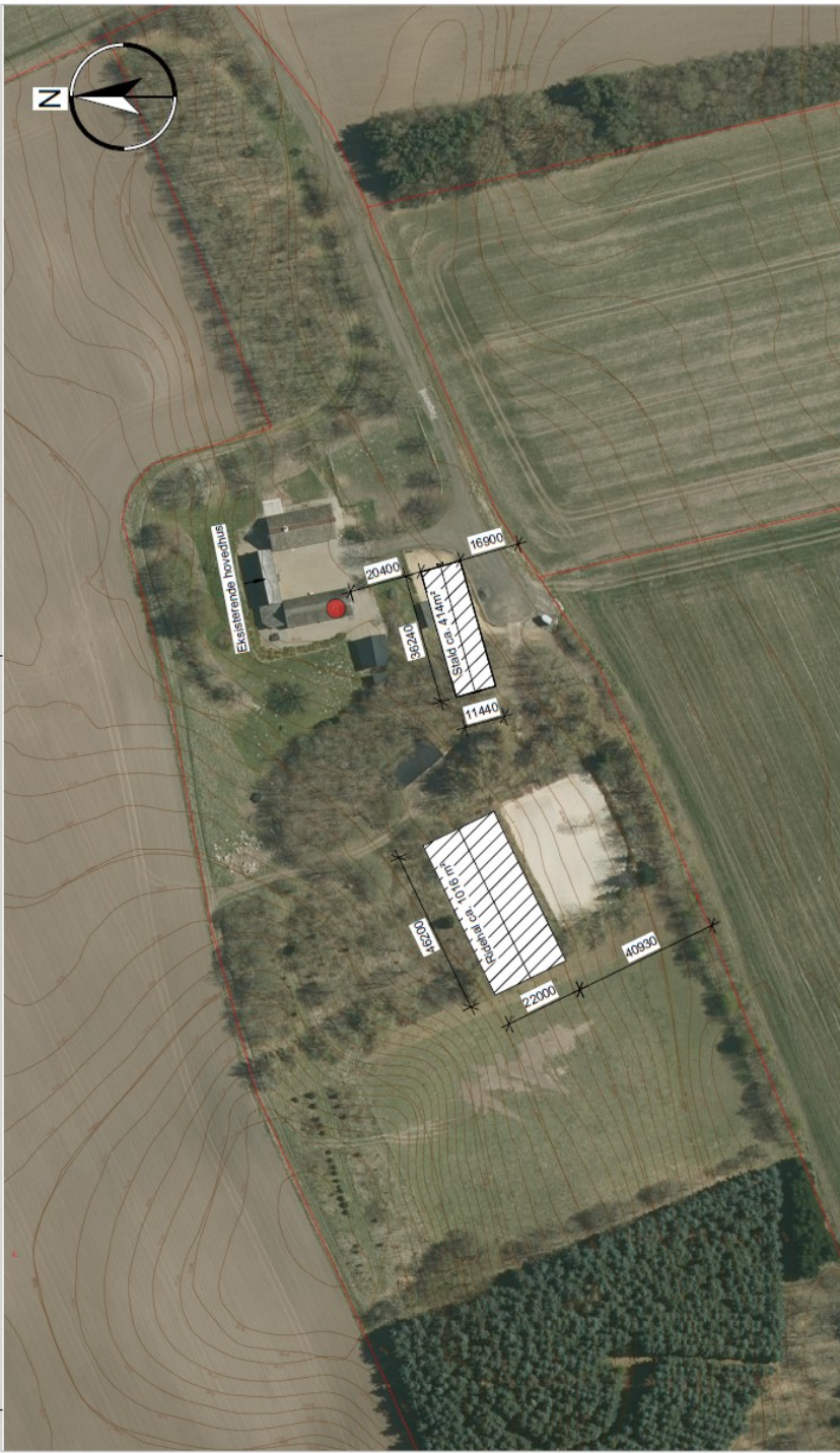
Situationsplan for husdyrbruget Røgenvej 55, hvor mål og placering af hestestald og ridehal fremgår. Ridebanen fremgår af luftfoto og har målene 25 meter x 40 meter.
