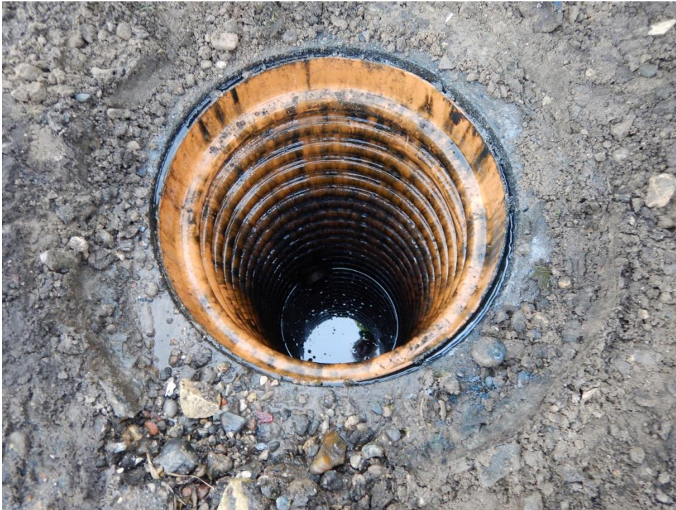
1. Sortfarvet rør i prøvetagningsbrønd.
