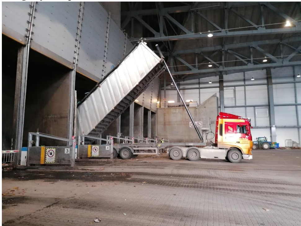
Aflæsning af biomasseaffald til silo
