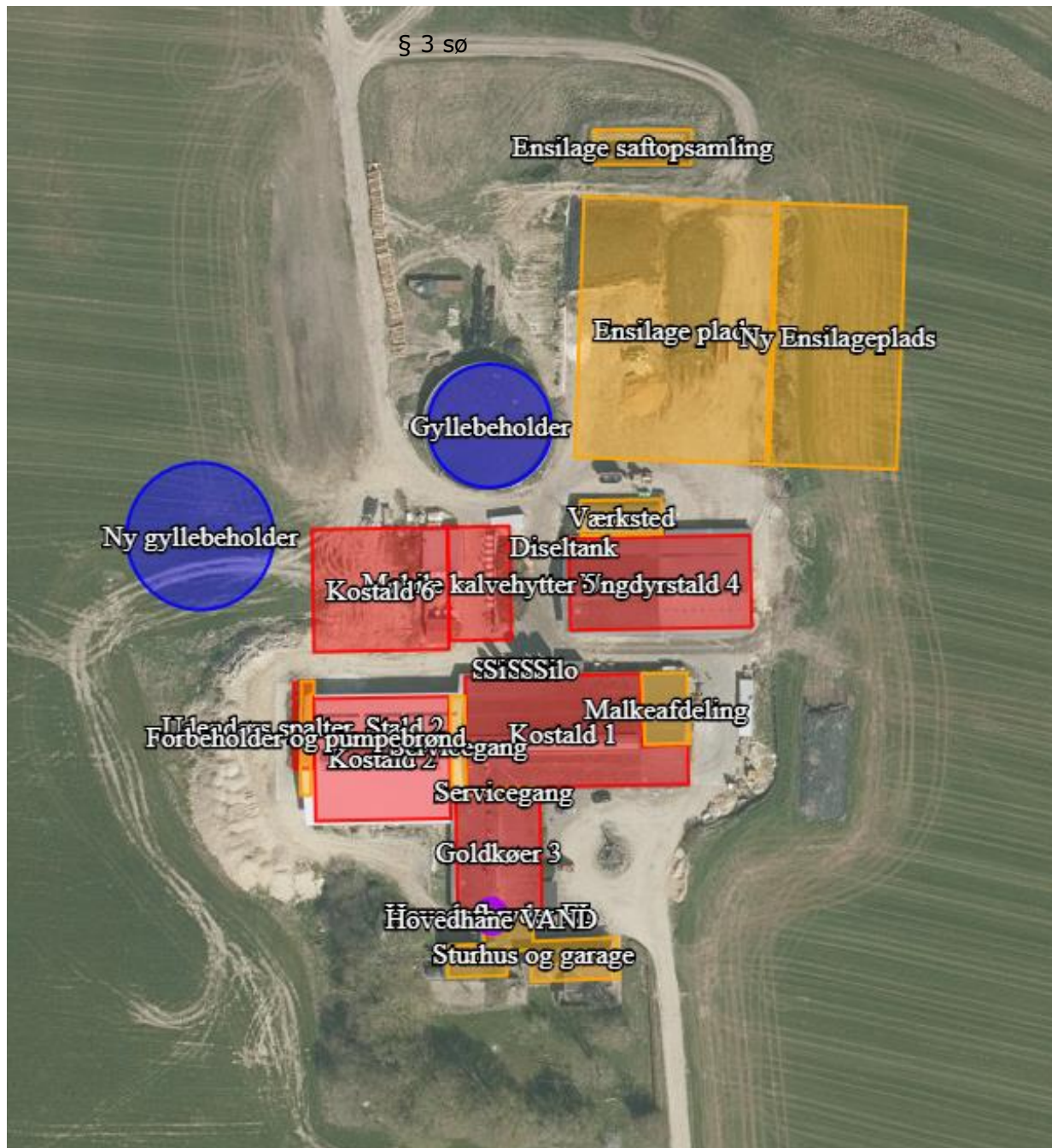
Figur 7.1. Oversigtstegning over eksisterende og nye bygninger
