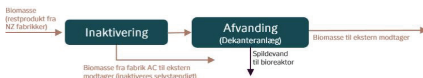
Figur 2: Simpelt flowdiagram over processen i Miljøteknik, inklusiv eksisterende processer samt de planlagte udvidelser
