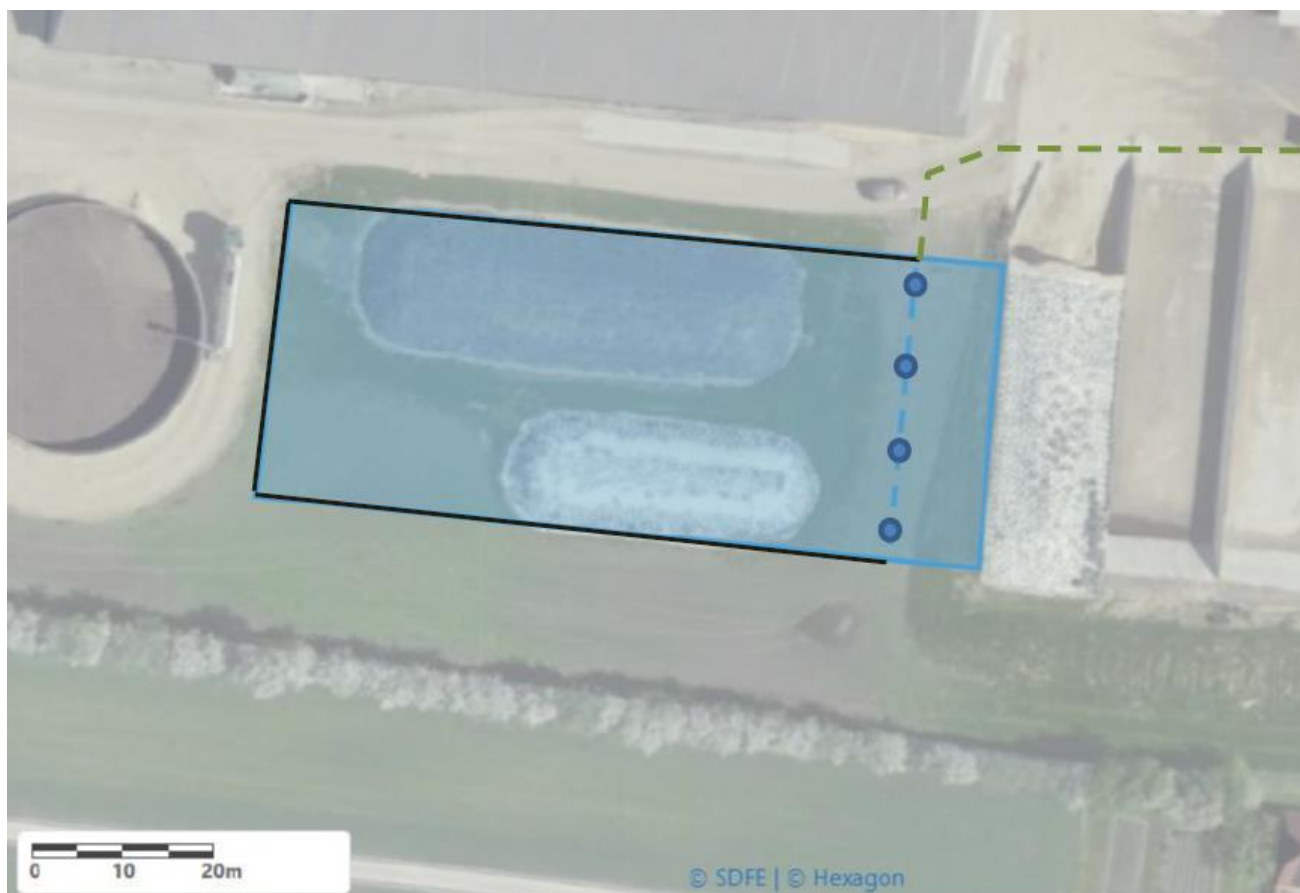
Figur 2 Plansilo markeret med blå farve. Etableres 14 meter syd for eksisterende staldbygning. Sort markering af vægge mod nord, vest og syd. Længde = 80 meter; bredde = 33 meter.
