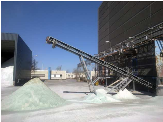
Håndtering af skår: Til venstre udlæsning af egne skår fra produktionen; til højre ses opbevaring af egne skår, samt transportør til oplæsning (fotos fra vinteren 2012/13).
