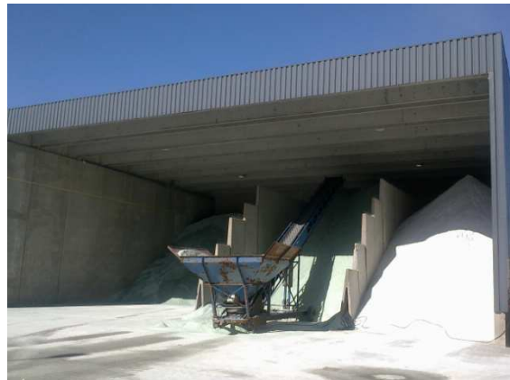
Håndtering af skår: Til venstre udlæsning af egne skår fra produktionen; til højre ses opbevaring af egne skår, samt transportør til oplæsning (fotos fra vinteren 2012/13).
