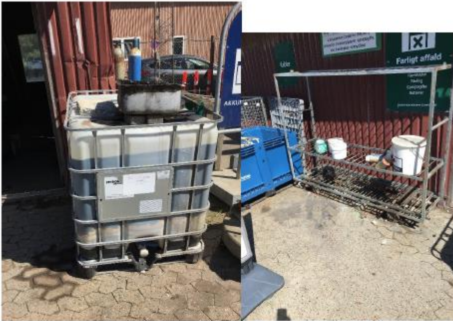
Figur 4 tv. 1.000 L pallettank til spildolie. Th. reol til indlevering af farligt affald på genbrugspladsen. Er placeret direkte oven på en FS-stenbelægning.
