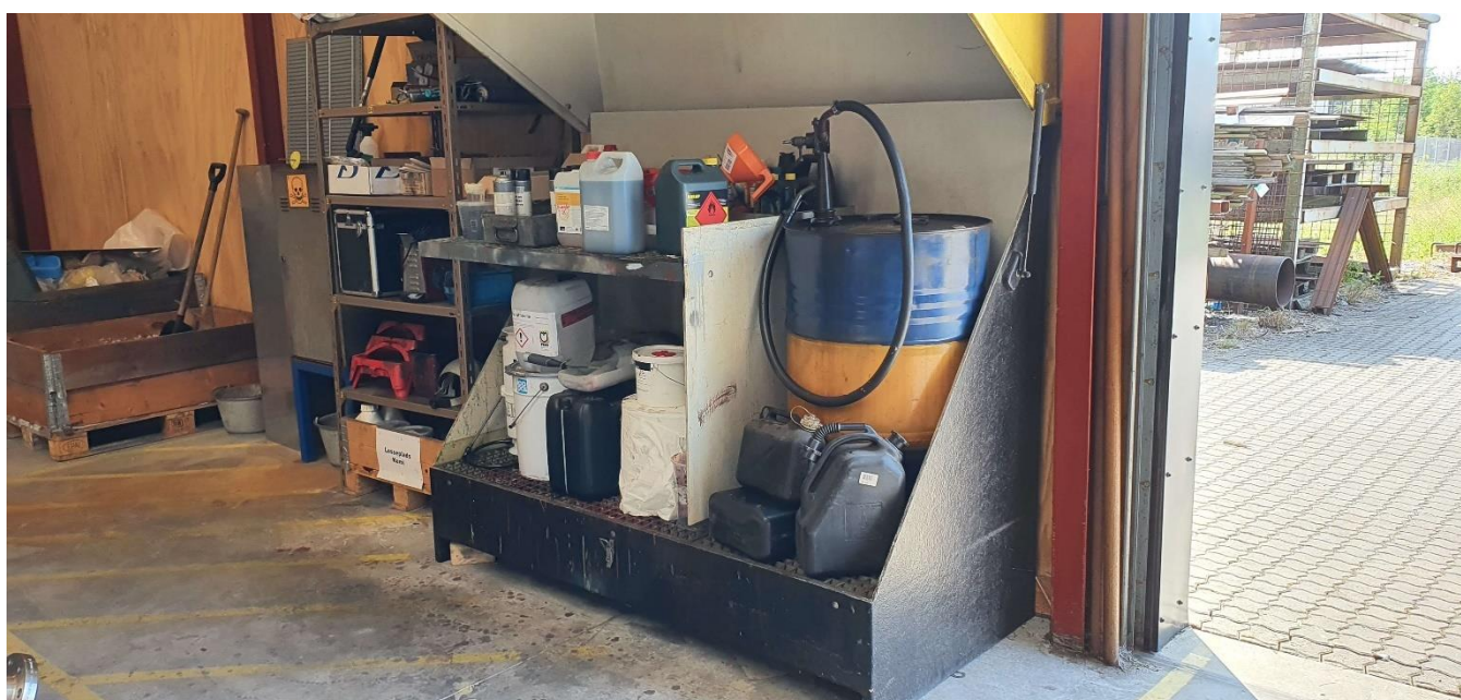
Dieselolie og andre flydende råvarer opbevares med spildsikring.
