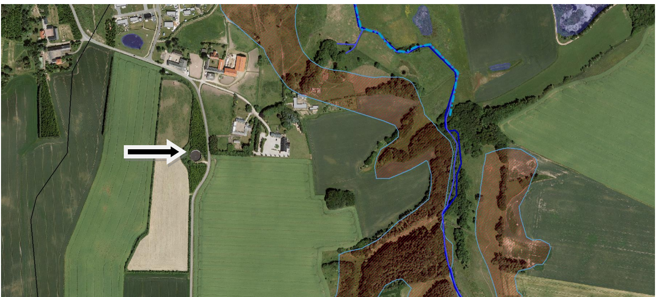
Placering af gyllebeholder ved Amstrupvej, matrikel 4mv, Amstrup By, Hvorslev inden for Brandstrup Bæks opland. Arealerne ned til bækken skråner 6-12 grader. Afstanden fra gyllebeholderen til bækken er cirka 550 meter.
