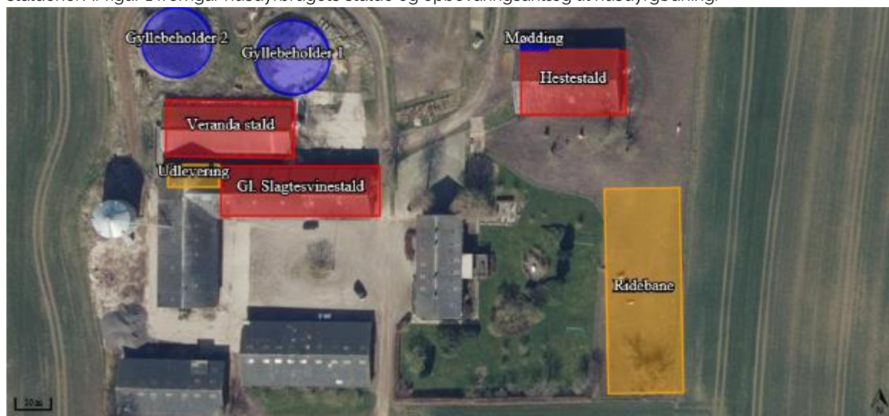
Figur 1: Husdyrbrugets stalde og opbevaringsanlæg til husdyrgødning. Kilde: husdyrgodkendelse.dk
