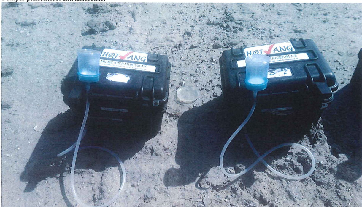
Pumper påmonteret filtrecassetter.
