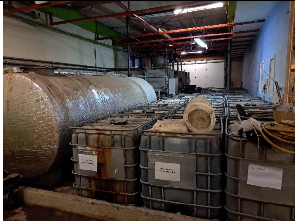
Figur 13. Kemikalietank og IBC-beholdere med kondensvand fra termobehandling og termovand opbevaret bag opkant.
