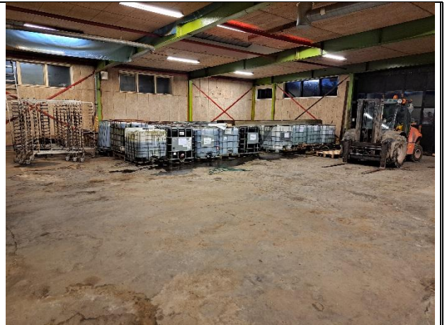
Figur 18. IBC-beholder med trykvæske med kobber og regnvand med trykimprægneringsvæske. Der er væske på gulvet ved IBC-beholderne hvilket kan tyde på at nogle af IBC-beholderne er utætte.
