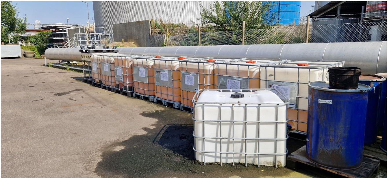
Oplag af terpentin i 8 stk. 1000 liters palletanke i tankgård uden fast bund.
