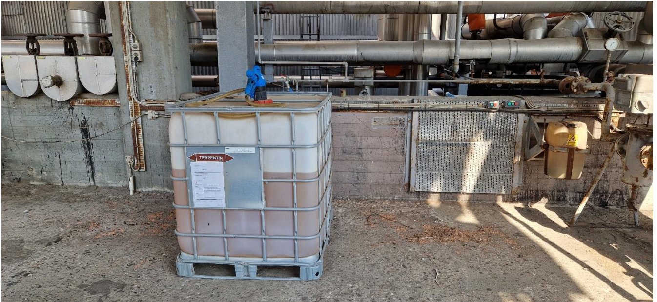
Oplag af terpentin i en 1000 liters palletank i nærhed af læsseramper, hvor der er afløb til regnvandssystemet.
