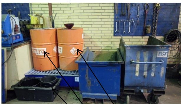
Billede nr. 1: Tromler med olier og spildolie samt minicontainere til oliefiltre mv. Balje med spande – spandene benyttes ifm. aftapning af spildolie.
