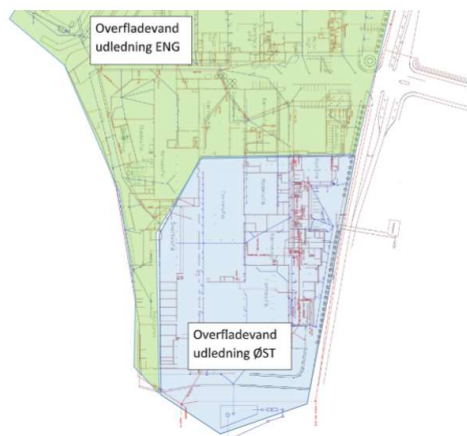
Figur 3: Oversigtstegning med opland tilknyttet det østlige bassin (blå farve). Bemærk at tegningen er vendt så øst er nederst.
