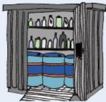
Figur 2: Udendørs opbevaring i container med dobbelt bund.
