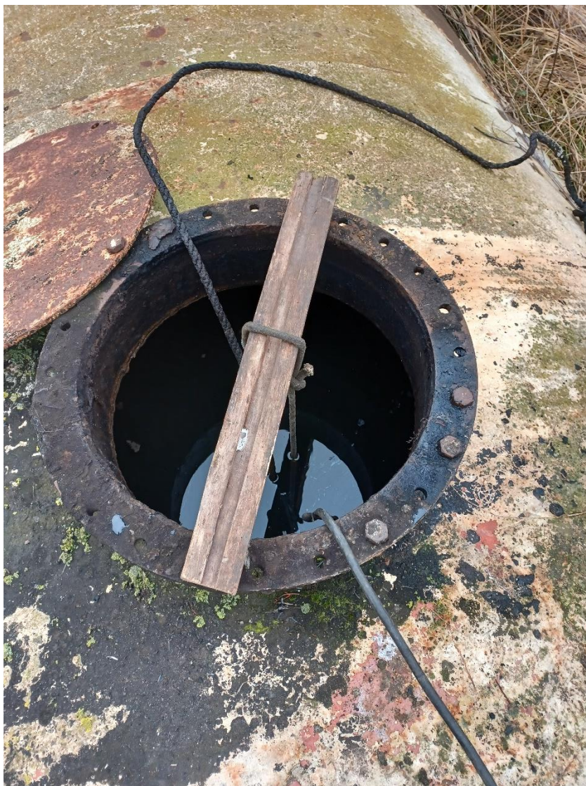
Billede 3 Dykmåler monteret i perkolattanken.
