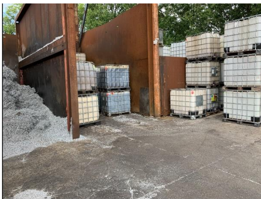
Foto af pallettanke med spildolie og borevand. Arealet har afløb til opsamlingsgruben. Pallettanke til højre i billedet er tomme.
