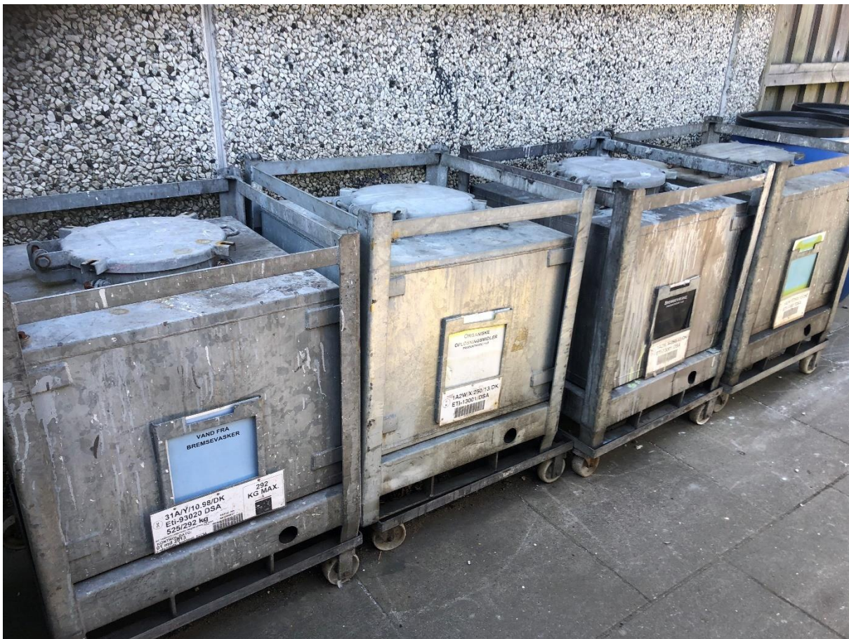
Billede 1. Opbevaring af farligt affald i IBC Tank Container fra ABAS på virksomhedens udendørs areal.
