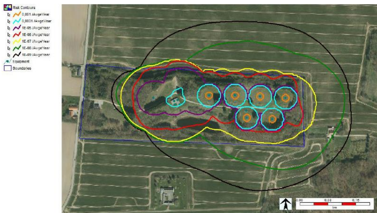
Figur 2: Stedbunden individuel risiko omkring FDO J8 Sort: Stedbunden individuel risiko på 10^{-9} . Rød: Stedbunden individuel risiko på 10^{-6} . Lilla: Stedbunden individuel risiko på 10^{-5} .
