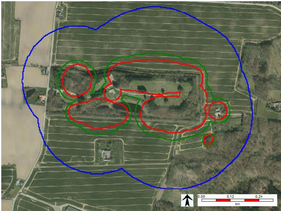
Figur 1: Maksimal konsekvensafstand for værst mulige uheld på FDO J8 Blå: 0,05 barg (personskade) Grøn: 0,15 barg Rød: 0,20 barg (dominoeffekt)
