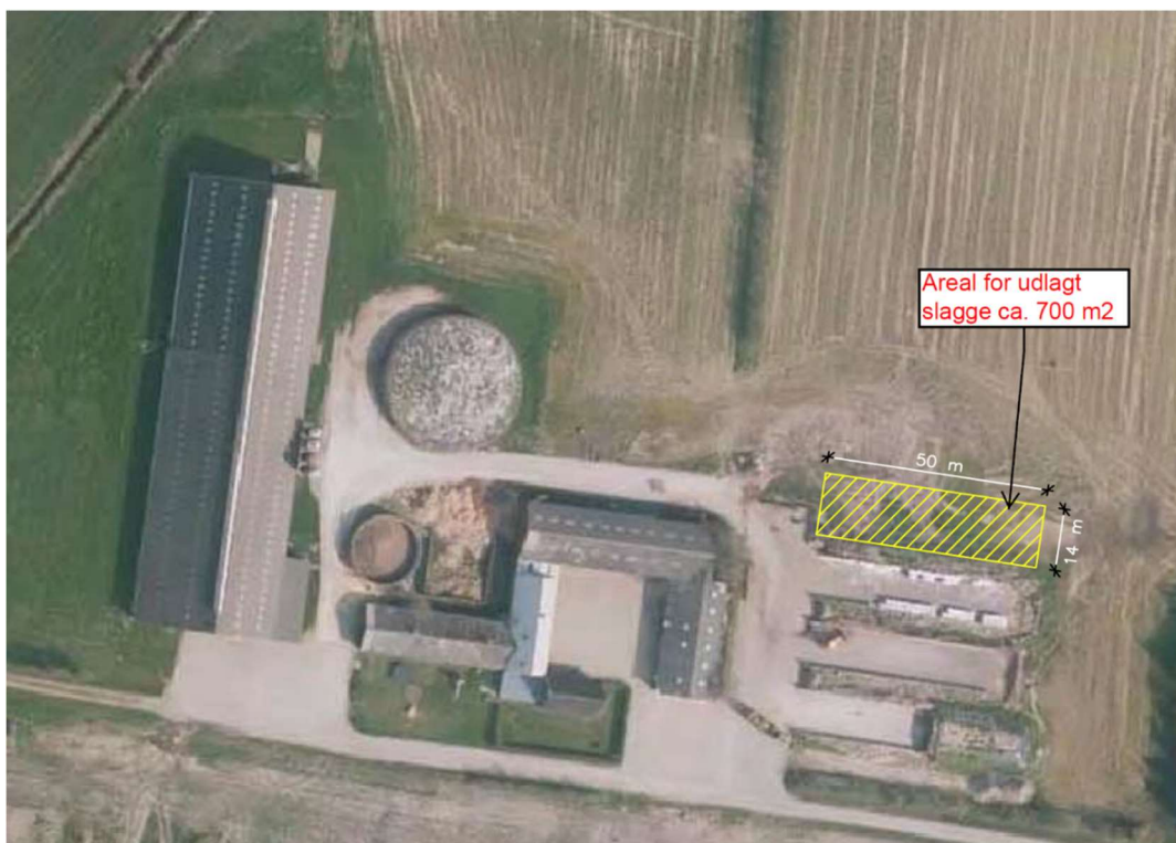
Kort 1: Placering af affaldsforbrændingsslagge. Der lægges slagge ud på det gule areal. Luftfoto fra situationsplan.
