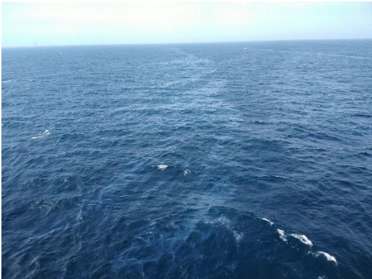
Figur 1. Billede fra tilsyn, som viser en svag antydning af oliefilm fra udledning af produceret vand efter rensning.
