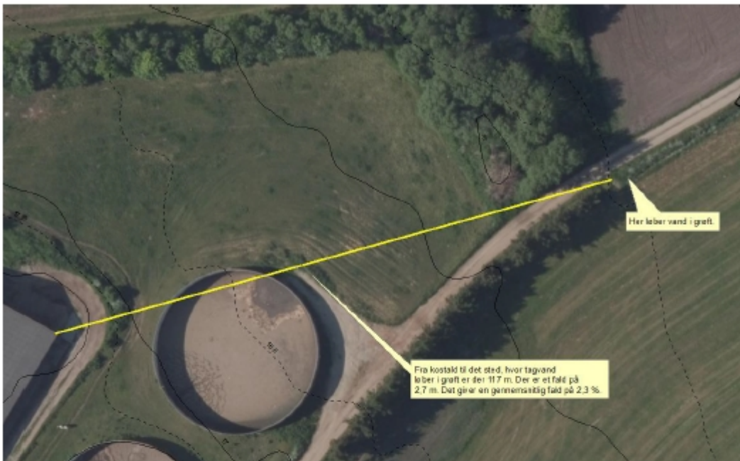
Figur 2. Hældning fra stald til grøft.
