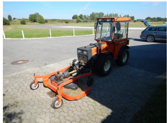
2. Vaskeplads. Traktoren er placeret på pladsen således, at hvis den skulle dryppe er den placeret ved olieudskiller.
